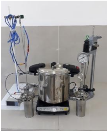
Alat prehidrolisis dan pemasakan
